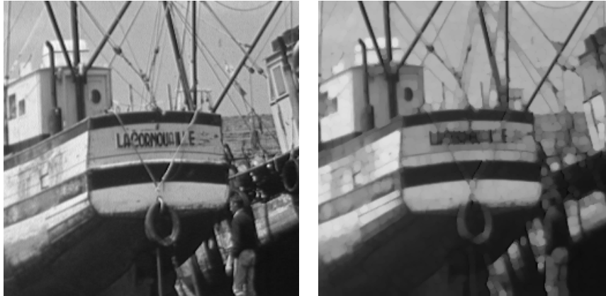
FIG. 6.8 – Exemple d’ouverture numérique (de gauche à droite : image initiale et ouverture par un disque de taille 3).
